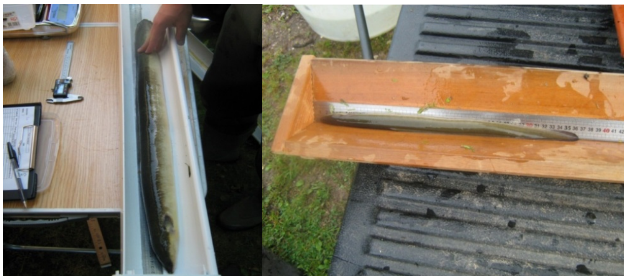
Figure 14 : Ichtyomètres de fabrication artisanale (en PVC à gauche, en bois à droite)
