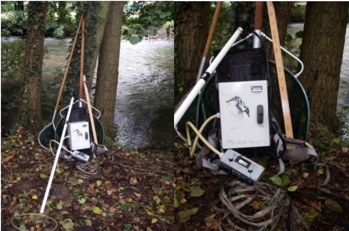
Figure 11 : Martin Pêcheur ® de chez Dream Electronique, épuisette à bord inférieur droit de 60 cm, épuisette mobile de section ronde et pige graduée pour la mesure des profondeurs d'eau.
