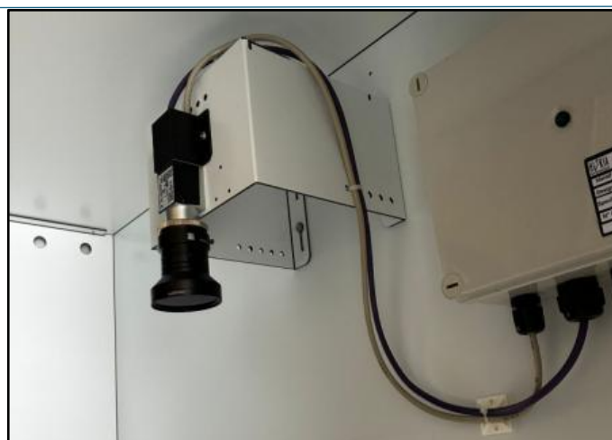
Figure 7 : Dispositif du Système Innovant de Comptages Automatique des Anguilles par Vision (SICA AV)
